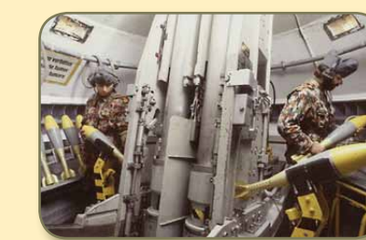
Panzerkugel eines 12 cm Fst Mw 59/83. Die Mienen werden mit den Ladungen auf Ladearme gelegt und eingeschwenkt, die Verschlüsse der beiden Rohre abtoben automatisch. Kadenz: 16 Schuss pro Minute.
